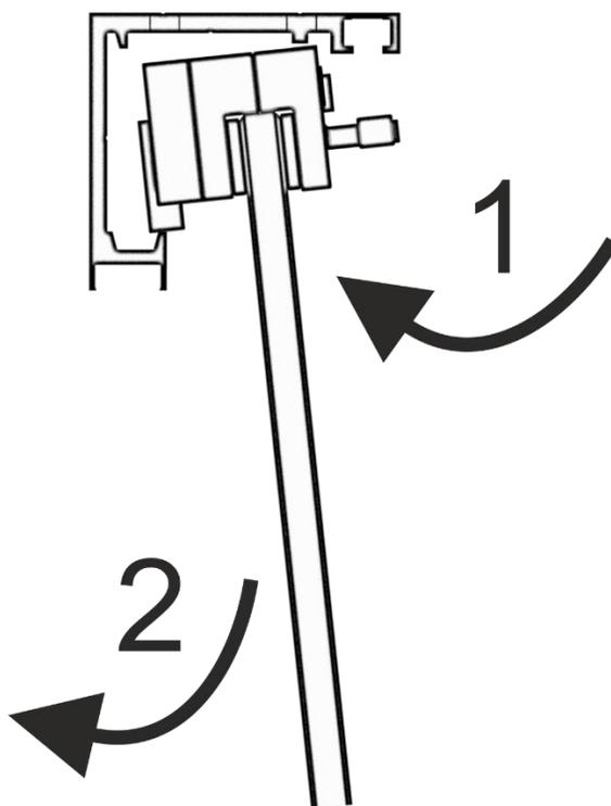
Регулируем высоту установленной двери шестигранным ключом.
