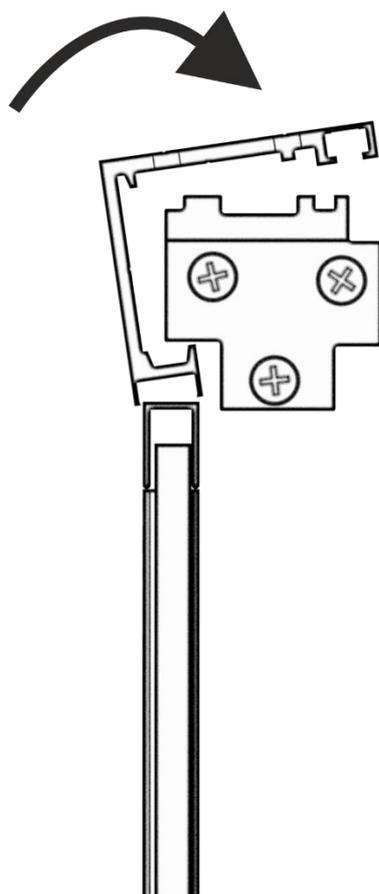
Фиксируем верхнюю направляющую в стеновые фиксаторы.
